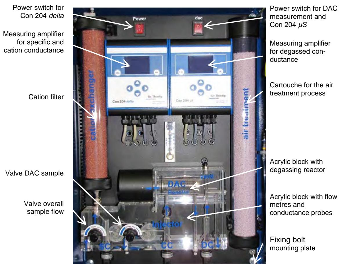
Fig. 1 Digox 601 dac setup
