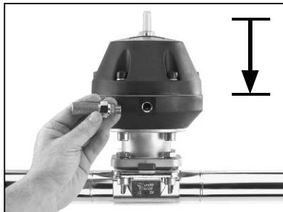
10. Ventil in Position „geschlossen“ bringen, manuell betätigtes Handventile nur in Position „halb geschlossen“ bringen.
