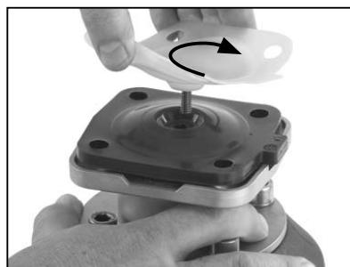
5. Neue Absperrmembrane in die Ventilspindel / das Druckstück einschrauben, bis ein deutlicher Widerstand zu spüren ist. Bei 2-teiligen Absperrmembranen den Elastomerrücken passgenau auf den Flansch des Ventilantriebs legen, das PTFE-Schild umstülpen und wie zuvor beschrieben verfahren.
