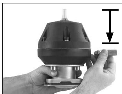
3. Ventilantrieb in Position „geschlossen“ bringen. Bei manuell betätigten Ventilantrieben darauf achten, dass sie nicht zu weit zgedreht werden und dadurch das Druckstück aus seinen seitlichen Führungen heraus läuft.
