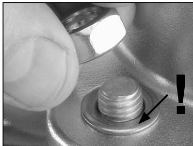
9. Verbindungsschrauben von der Körperseite her ansetzen und mit Ventilkörper / Muttern handfest über Kreuz verschrauben (ohne Kraft). Unterlegscheiben nicht vergessen!
