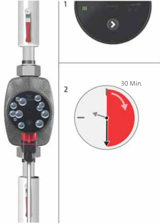
Şekil 8 Pompanın havasının alınması
