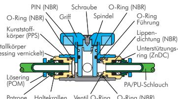
**Werkstoffe:** Körper: Messing vernickelt/PA 66/PPS, Dichtung: NBR, Haltekralle: Edelstahl, Patrone: ZnDC vernickelt, Lösering: PA 66 (bei der Montage werden ausschließlich silikonfreie Dichtungen und Schmierstoffe verwendet)
